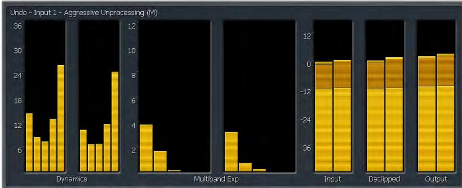
Expander Ratio扩展率表指示的是相对所测输入动态的实时扩展率，动态性低的素材相对动态高的素材，具有较高扩张率，如上图。
