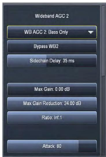
Wideband AGC2菜单决定了采用何种压缩方式及何地开始，以及采用何种适合增益和控制速度：
