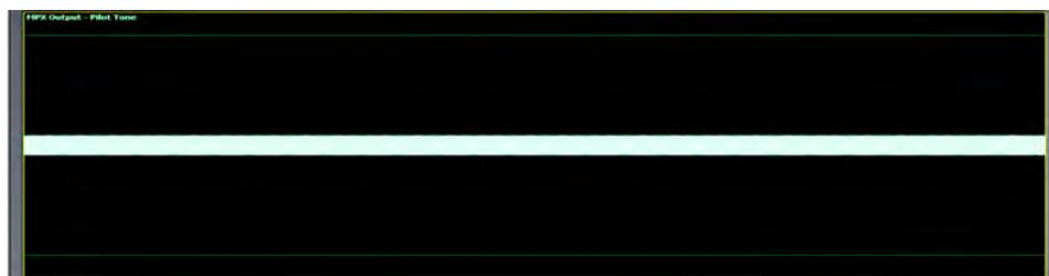
注意你现在所看到的图形就是从整个MPX信号的实际导频中截取的，相较其他未做导频的MPX信号可以明显看出复合信号被紧密压缩而且峰值电平实际上升了（导流层被移除），这与您所发现的其他处理器（除Omnia9）完全相反。
