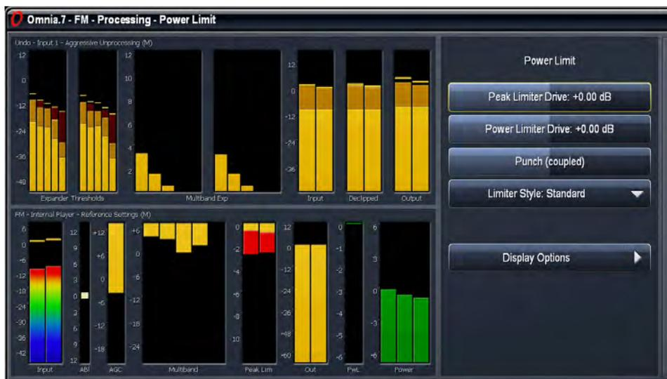
Peak Limiter Drive峰值限制驱动功能用来设置最终峰值限幅器产生的限幅数值，有12 dB的范围并以1/4 dB步进调整。这些限幅器与HD及流媒体核中使用的一样，适合在预加重之前使用。
