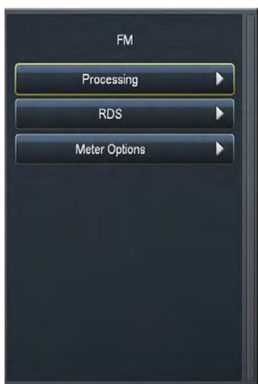
调频菜单包含Processing处理，RDS无线电数据系统，及Meter Options指示表选择
