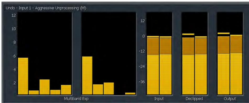
动态探测参数表显示的是测试到的各频段动态参数，柱状高低表明声音源的连续动态差异性（高者名予高），这些参数刚好与扩展率显示成反比，如上图。
