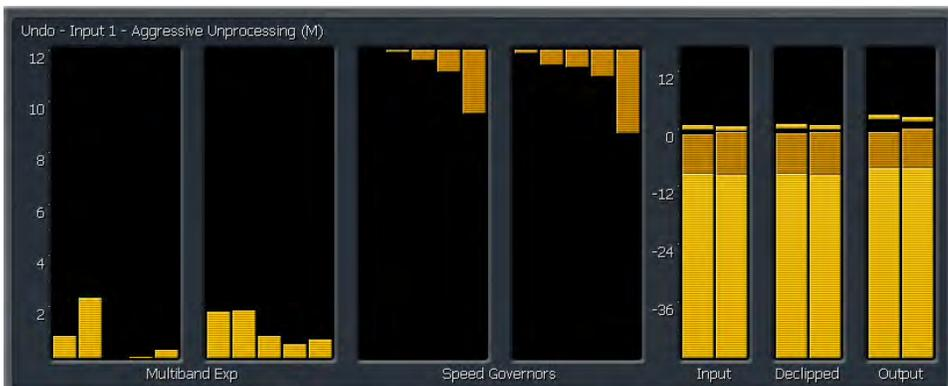
Expander Threshold扩展门限指示表同时展示4个不同扩展活动的测量参数，亮黄色柱表示平均电平，橙黄色标示电平峰值，暗红色标示距离限位（单频道峰值可测的最大距离至可防宽频电平扩展参数），黄色跳跃参数示峰值，如下图。
