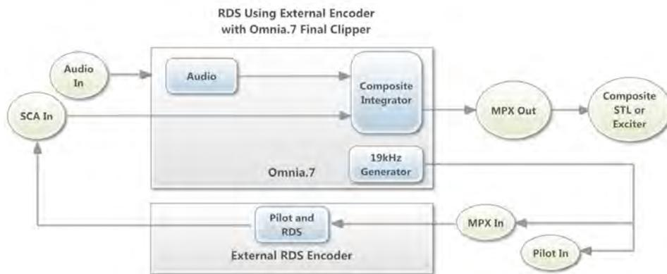
必须确保在RDS模式下打开适合的MPX输入(Input 1 or Input 2)给RDS使用，将MPX2输出设置为19 kHz发生器模式，MPX2输出模式可以在RDS菜单，FM Processing Output（调频处理输出）菜单和main I/O（主I/O）菜单下找到。
