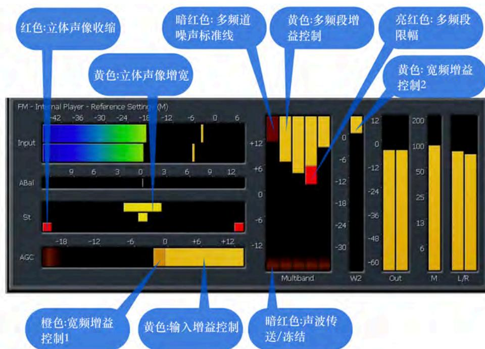
数据表头提供各种应用如:输入电平监控,输入自动增益控制,宽频自动增益控制1,多频自动增益及限幅控制,多频噪声衰减,多频立体声增强,宽频AGC2后多频输出调制,MPX格式输出,高清HD区独立的左右声道输出,以及在保留MPX输出并取消AGC输出的情况下,最终前视峰值受限而处理中心最终输出被强加入的数据控制.
