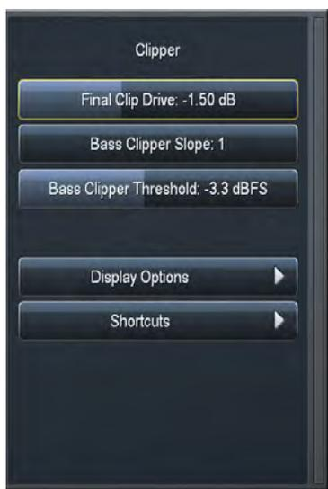
Clipper 削波功能菜单控制着最终削波驱动，低音削波斜度及低音削波门限3个参数
