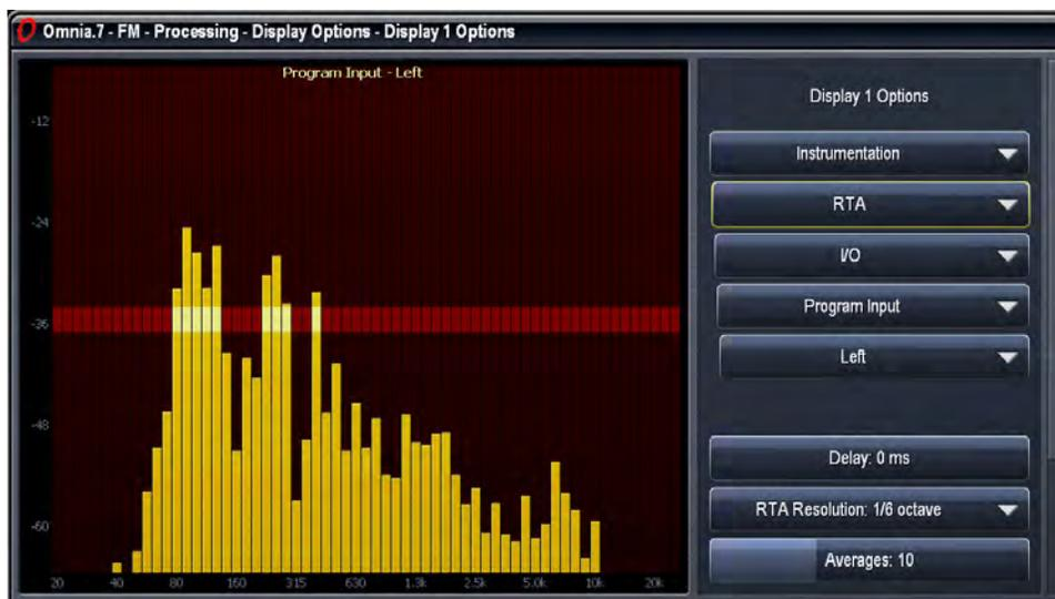
Category分类类型，PatchPoint节点及AudioChannel音频通道子菜单用来选择特定音源，特定的节点会根据分类改变，类型包含有I/O输入/输出，Undo恢复还原，Miscellaneous混音，MPX Decoded MPX解码，Physical Inputs物理输入，Parametric EQ Preview变量EQ预置，Sidechains边串（外围）电路，Multiband多频，and Monitor Out取消控制。
