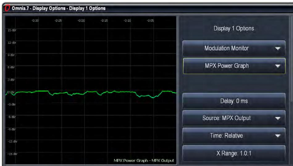
选择调制表显示MPX及左右调制电平，导流层次及MPX功率水平值。通过表选项中的选择显示
