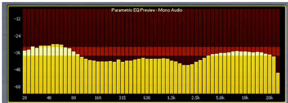
您现在可以在RTA显示窗口观察到PEQ曲线，你也可以通过选择单一频道按钮来观察多频压缩后的每一个频道的波形曲线。因为单一频道与处理器中动态区域状况联络密切，降低均值会得到更多实时图形
